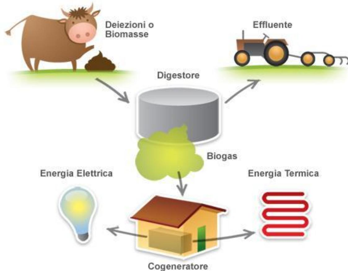
La digestione anaerobica è un processo biologico complesso nel quale, in assenza di ossigeno, la sostanza organica contenuta nelle biomasse viene trasformata in biogas, un gas biologico formato prevalentemente da biometano e da anidride carbonica.
